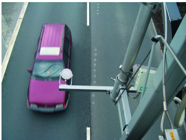
Детектор контроля дорожного движения серии TEU, установленный на мосту
